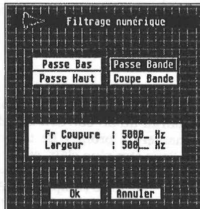
Le premier filtre ne conserve que les fréquences inférieures à la fréquence de coupure, donc les graves. A l'opposé, le *passé-haut* conserve les fréquences supérieures, donc les aigus. Le *passé-bande* filtre les fréquences avant et après la fenêtre, et le *coupe-bande* retire les fréquences comprises dans cette fenêtre. On entend par fenêtre la zone comprise autour de la fréquence de coupure, et de la largeur donnée.
